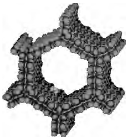
Figuur 7.1: Voorstelling van een hexagonale porie van MCM-41.
