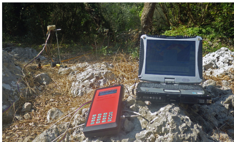
Fig. 5. De lichtgewicht elektrische weerstandsapparaat 4PointLight met veldcomputer in actie buiten de grot La Sassa, juli 2016 (foto B. Ullrich, Eastern Atlas GmbH & CoKG).
