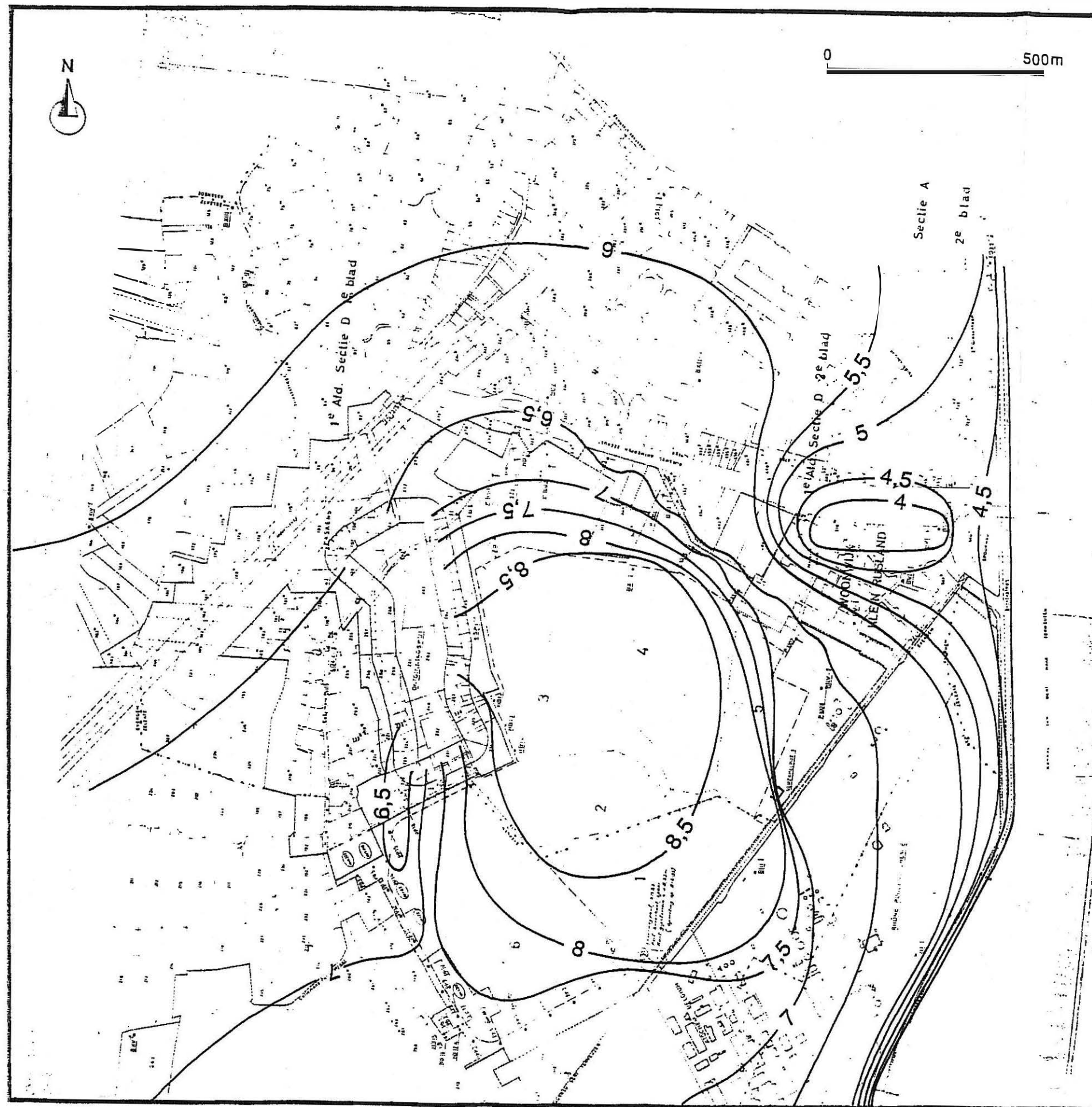
Fig. 12 - Stijghoogten in september 1994 in de laag KZ1
