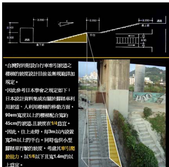
圖 9 承德橋人行道與橋下堤防間附設自行車牽引坡道，應考慮自行車牽引道之爬坡能力。
