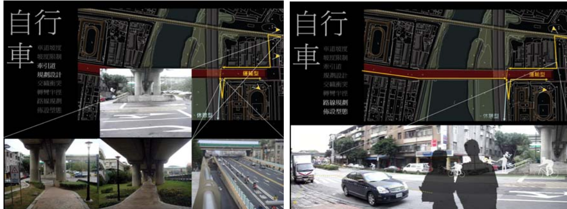
圖 11 承德橋南向捷運線通往承德-敦煌路口處，模擬前(左)及模擬取消路邊之停車帶改建成為自行車道(資料來源：本研究模擬繪製)。
