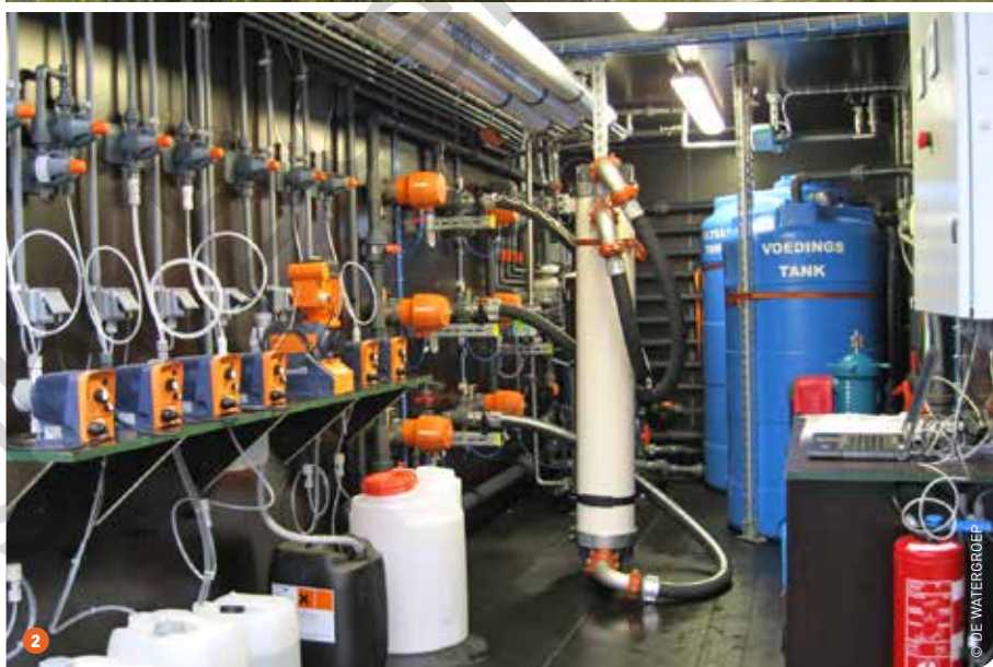
1 Constructed wetlands. 2 Met de mobiele container van De Watergroep werd gezocht naar de beste cascade van technieken om effluent afkomstig van mestverwerkende constructed wetlands verder op te zuiveren tot de gewenste kwaliteit.
