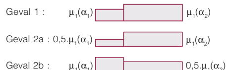
Afb. 2 Belastingsgevallen voor een dak met twee dakschilden ([1], afb. 5.3).
