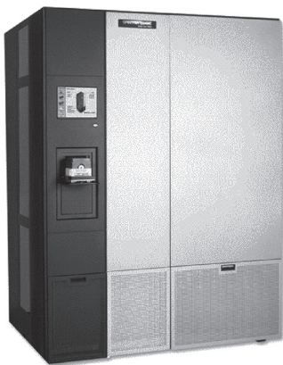
FIGUUR 14: Een Spectralogic T950 robot met 1 extra frame aan de rechterkant (totaal ongeveer 950+1100 tapes)
