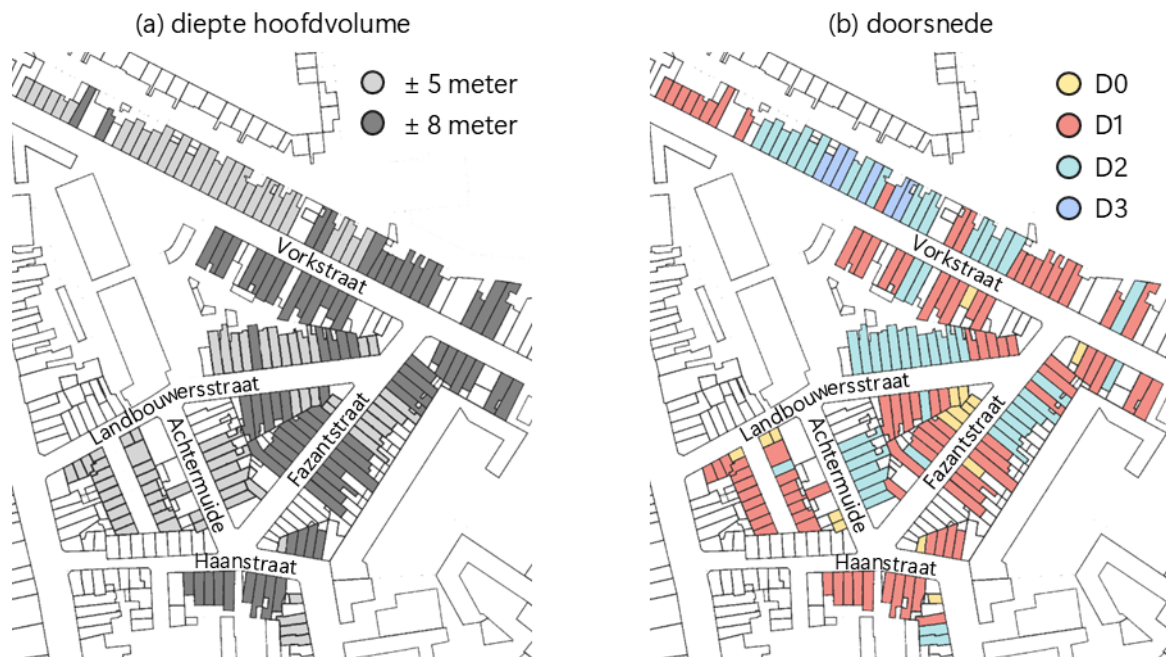
Figuur 2 Typologische analyse van een deel van de wijk: (a) diepte van het hoofdvolume en (b) doorsnedetypen gerelateerd aan de aanbouw.
