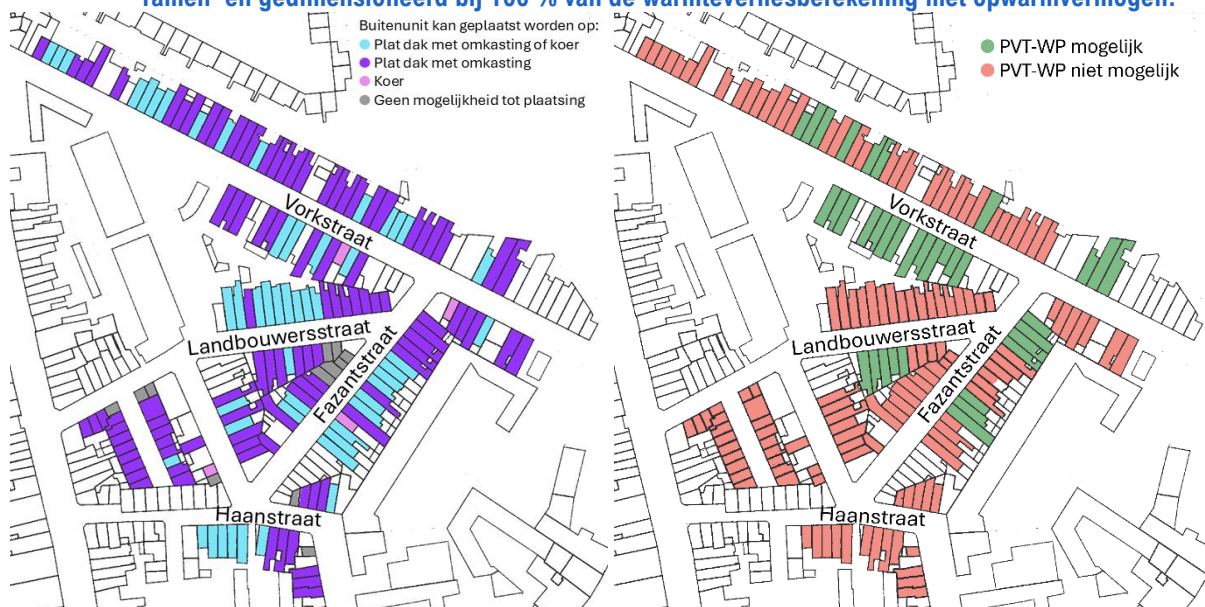
Figuur 33 Mogelijkheid plaatsing buitenunit (links) en PVT-panelen (rechts) bij isolatiegraad 'S3: dak en ramen' en gedimensioneerd op 70 % van de warmteverliesberekening zonder opwarmvermogen.
