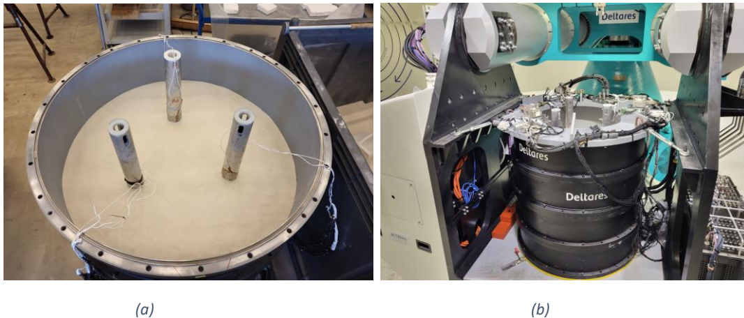
Figuur 3 Experiment windturbine. (a) drie monopiles in de proefbak, (b) de opstelling met activators en sensoren in de basket van de GeoCentrifuge.
